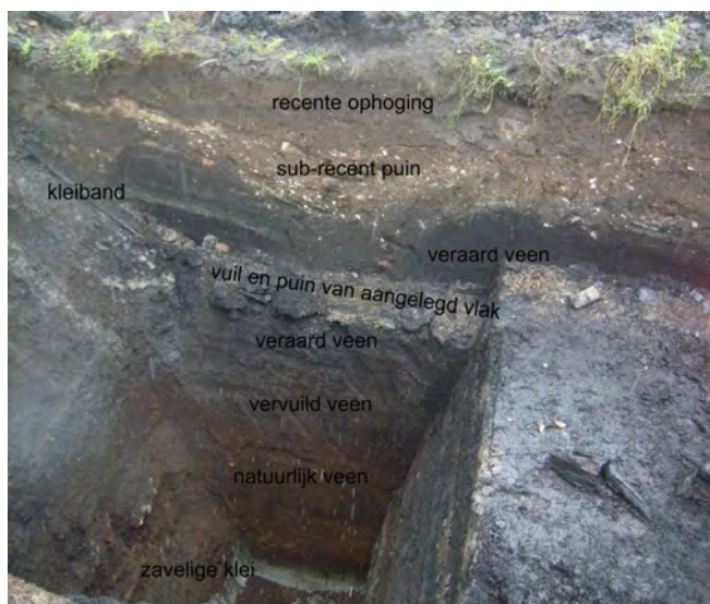
afbeelding 15, opbouw van de ondergrond Dorpsstraat 28-30
